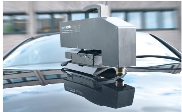
Abb. 2 Die optische 3D-Oberflächeninspektion eignet sich sowohl für den Labor- als auch den anspruchsvollen Industrieinsatz, z. B. in der Automobilindustrie zur Kontrolle des Lackerscheinungsbildes (Bild: NanoFocus)
